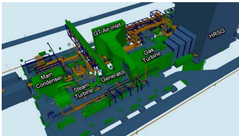
Gambar 4.4 Susunan Mesin Utama PLTGU Yang dibangun
