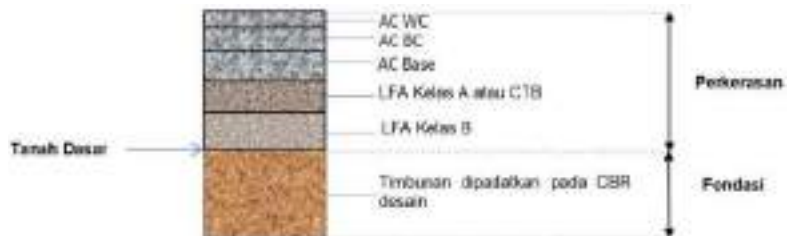
Gambar 2.1 Tipikal Struktur Perkerasan Lentur pada Timbunan Sumber: Manual Desain Perkerasan 2017
