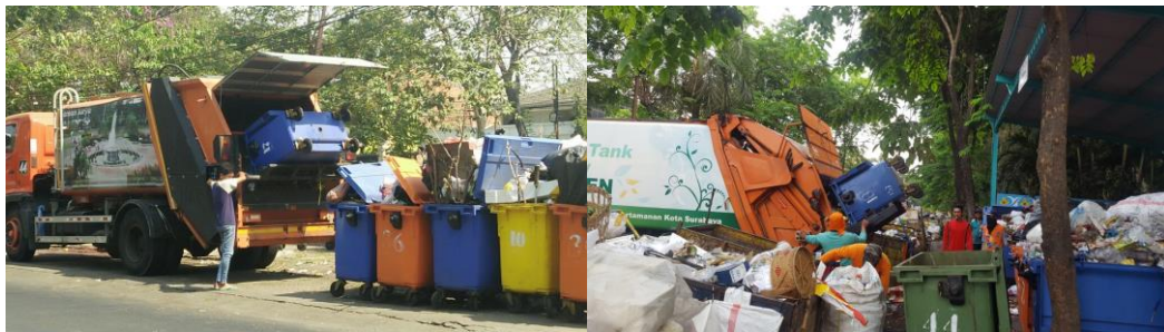
Gambar 1.2 Proses Loading Kontainer pada Truk Compactor
