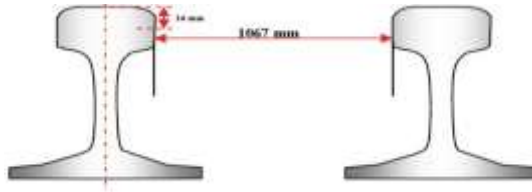
Gambar 2.3 Lebar jalan rel 1067 mm Sumber : Menteri Perhubungan RI. 2012.
