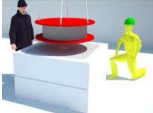
Gambar 100. Perletakan Base Isolator (Suardi, 2013)
