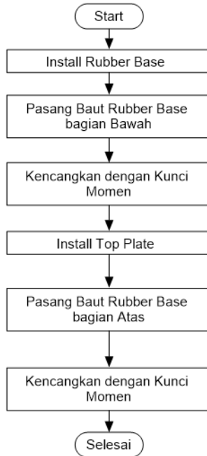
Gambar 99. Flowchart Pemasangan Seismic Base (Suardi, 2013)
