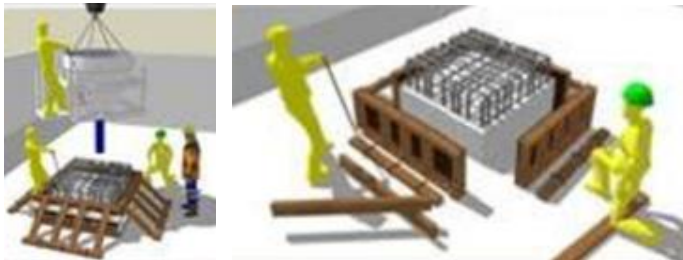
Gambar 93. Proses Pengecoran Kolom Pedestal dan Pelepasan Bekisting ( Suardi, 2013 )
