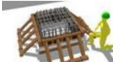
Gambar 92. Pemasangan Bekisting pada Kolom Pedestal ( Suardi, 2013 )
