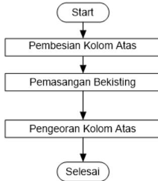
Gambar 102. Flowchart Pemasangan Kolom Atas (Tanaya, 2018)
