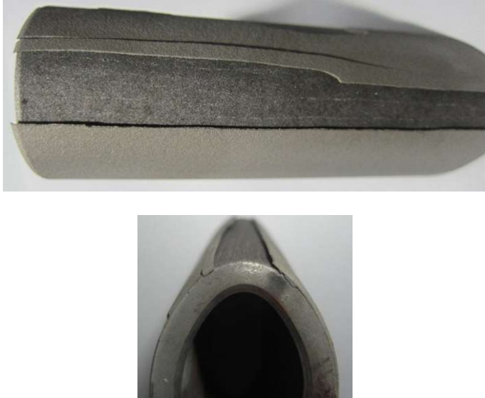
Gambar 4. 11 Spesimen flattening 37mikron
