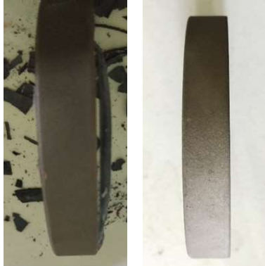
Gambar 4. 15 spesimen 37 mikron sesudah dan sebelum oksidasi
