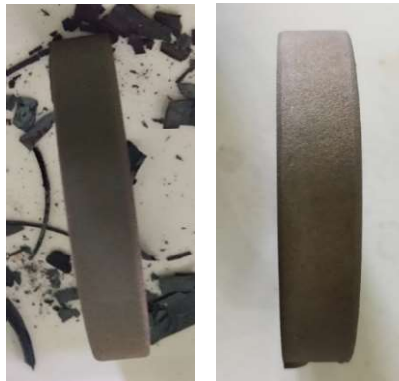
Gambar 4. 14 spesimen 50 mikron sesudah dan sebelum oksidasi
