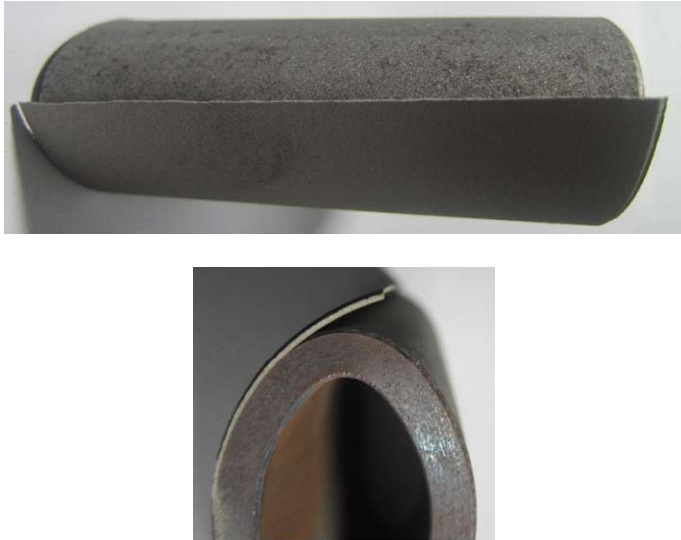
Gambar 4. 10 Spesimen flattening 50mikron
