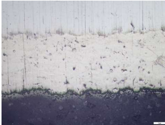
Gambar 2. 5 mikrostruktur HVOF dari NiCrBSi-30%SiC Sumber : Tugas Akhir Dhio
