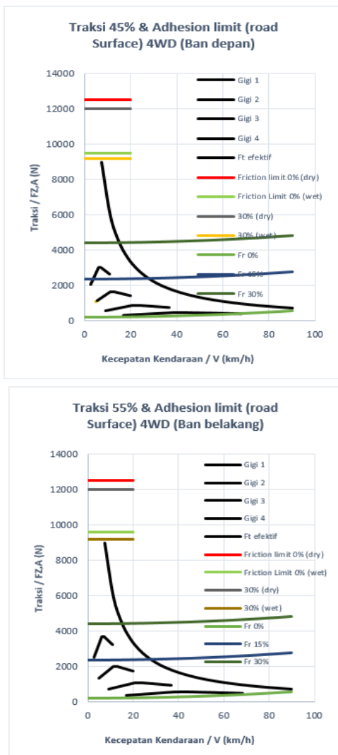
Gambar 2.2 Traksi dan Adhesion Limit pada 4WD dengan Variasi Traksi 45% Roda Depan dan 55% Roda Belakang [2]
