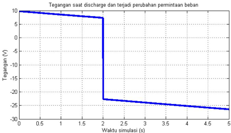
Gambar 4.14 Tegangan baterai saat *discharge* dan terjadi perubahan permintaan beban
