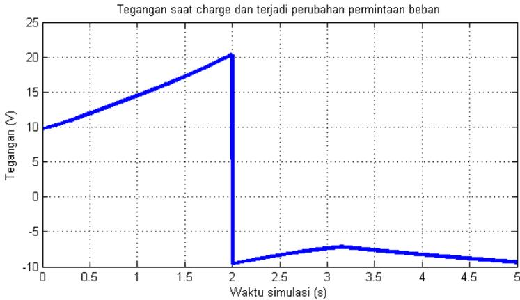
Gambar 4.8 Tegangan baterai saat *charging* dan terjadi perubahan permintaan beban
