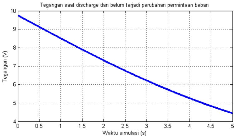
Gambar 4.12 Kondisi tegangan saat proses *discharge*
