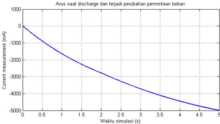
Gambar 4.15 Arus saat *discharge* dan terjadi perubahan permintaan beban
