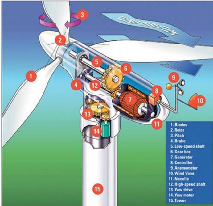
Gambar 2.1 Komponen-komponen turbin angin (Manwell J., 2009)
