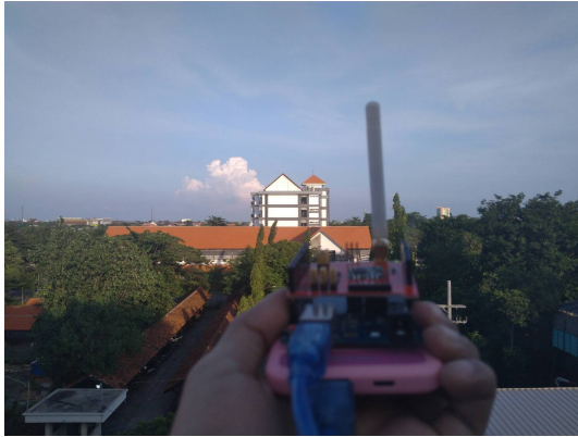
Gambar 7: Penempatan LoRa Anchor 2 untuk Pengujian.
