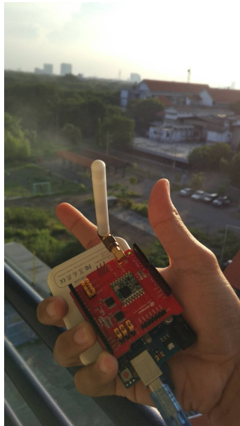
Gambar 8: Penempatan LoRa Anchor 3 untuk Pengujian.
