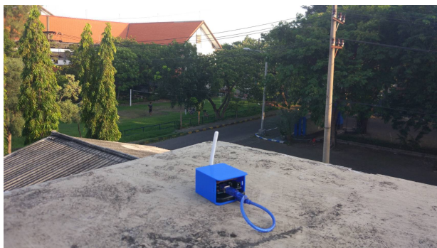
Gambar 5: Penempatan LoRa Node untuk Pengujian.
