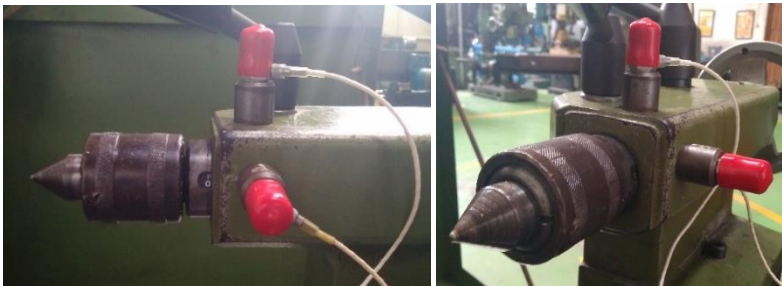
Gambar 4.7 Peletakan probe pada tail-stock mesin bubut
