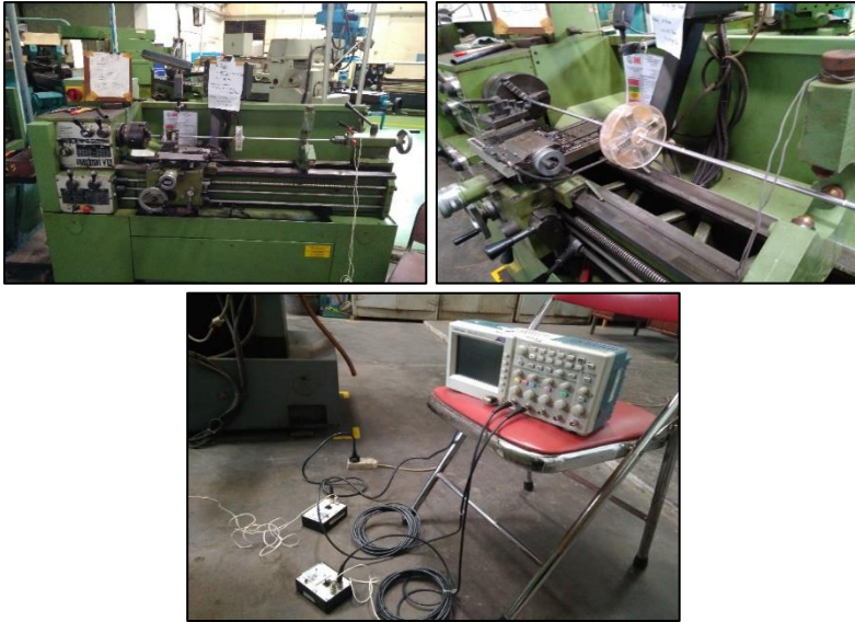
Gambar 4.2 Instalasi Eksperimen Sistem Utama dengan RVD
