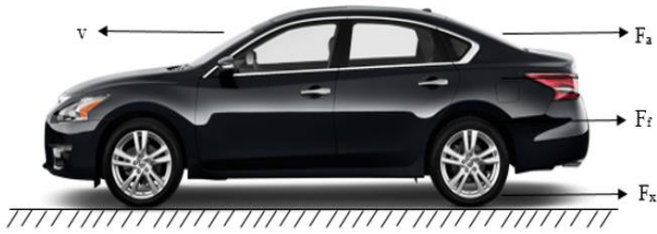
Gambar 3.3 Dinamika gaya yang bekerja pada kendaraan untuk quarter car model (Tur, Ustun, & Tuncay, 2007)
