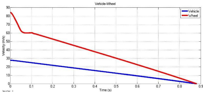
Gambar 4.3 Respon kecepatan kendaraan dan kecepatan roda dengan Sliding Mode Controller
