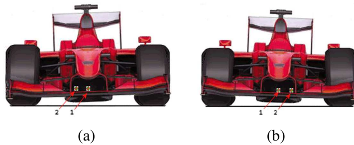
Gambar 2.12 Ilustrasi Perpindahan Beban : (a) Saat Belok Kanan, (b) Saat Belok Kiri (Anon., 2018)
