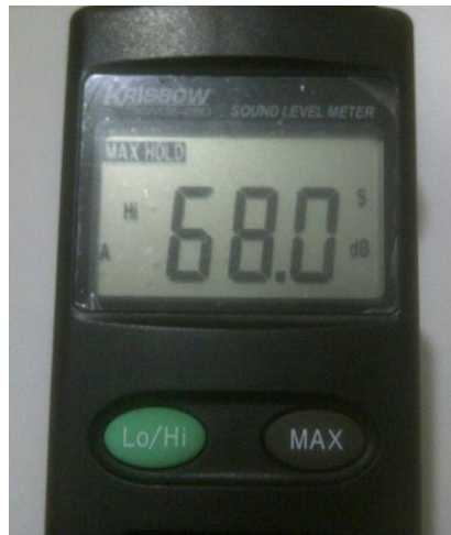
Gambar 3.14 Mengatur Set Up Sound Level Meter
