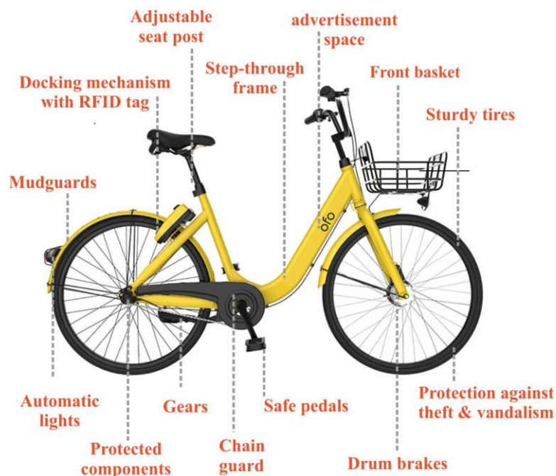
Gambar 9 Anatomi sharing bike pada sepeda
