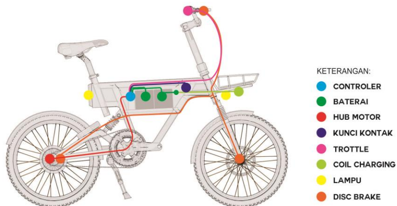
Gambar 47 Ilustrasi jalur kabel komponen pada sepeda
