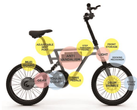
Gambar 44 Ilustrasi pengaplikasian komponen sharing bike pada sepeda
