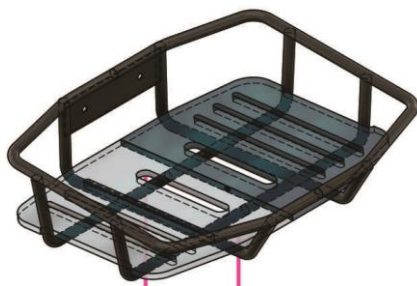
Gambar 26 Desain storage pada sharing bike
