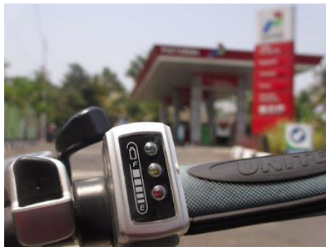
Lampiran Gambar 3 thumb trotle yang sudah terpasang pada sepeda
