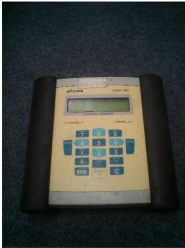
Flowmeter untuk mengambil data berupa kecepatan aliran dan volume total dari fluid yang melewati bisa digunakan untuk mengukur aliran di dalam pipa maupun tempat terbuka. Biasa dibawa oleh teknisi bagian maintenance.
