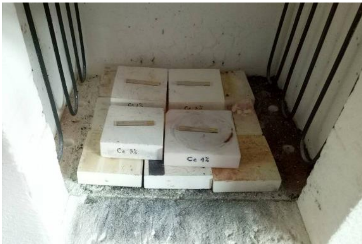
Sampel dimasukkan kedalam furnace
