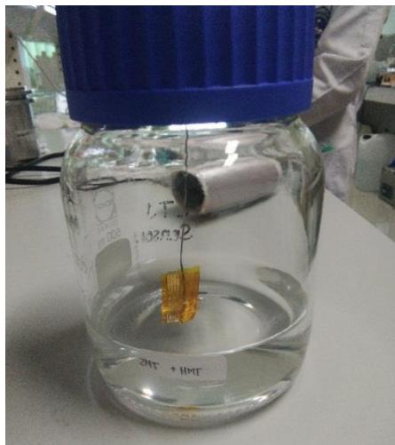
Perendaman sampel pada larutan ZnO nanorods
