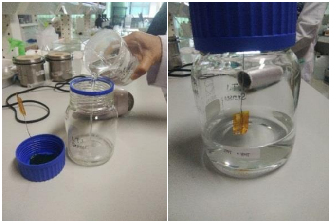
Gambar 3.5 Proses perendaman sampel pada larutan ZnO nanorods
