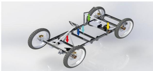
**Gambar 3.3 Free body diagram pada chassis nogogeni V**
