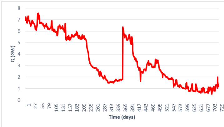
Gambar 4.7 Heat duty ( Q ) pada satu unit heat exchanger
