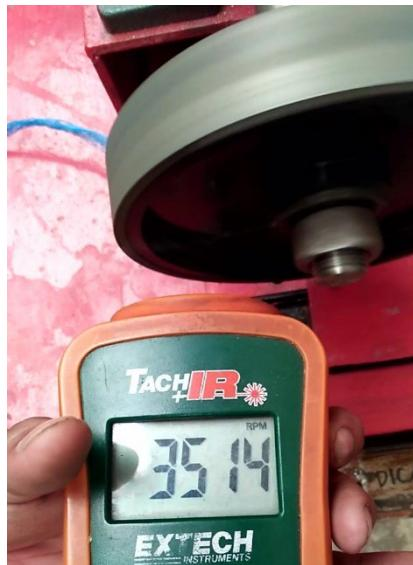
**Gambar 3.4** Proses Pengukuran RPM
