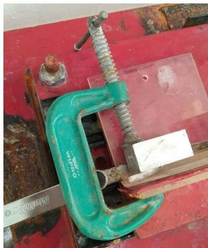
**Gambar 3.20** Benda Kerja Dijepit dengan *C Clamp*
