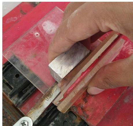
**Gambar 3.19** Penempatan *Feeler Gauge* dibawah Benda Kerja.
