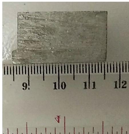
**Gambar 4.8** Hasil Penggerindaan Secara ECG dengan Arus 50A dan Konsentrasi Elektrolit 150 gr/l
