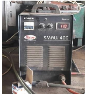
Gambar 3.8 Mesin las SMAW Focus 400A
