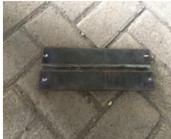
Gambar 3.7 Foto Material Setelah digerinda
