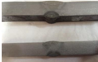
Gambar 3.24 Spesimen setelah diuji etsa
