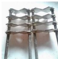
Gambar 3.3. Rangkaian plat stainless less positif (+) dan negatif (-)
