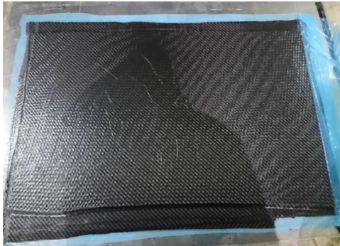
Gambar 3.23 composite sandwich sudah jadi
