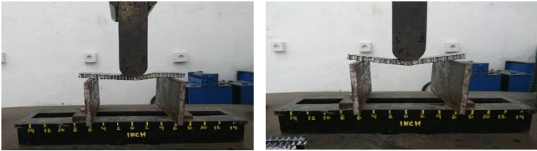
Gambar 3.28 Pengujian (a) sudut 0^\circ , (b) sudut 30^\circ ,
