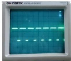
**Gambar 4. 5** Sinyal Pulsa Ketika *Rotary Encoder* Membaca Kecepatan
