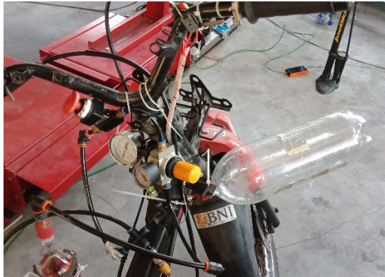
Gambar 3.2. Instalasi percobaan engine yang telah dimodifikasi berbahan bakar ethanol.
