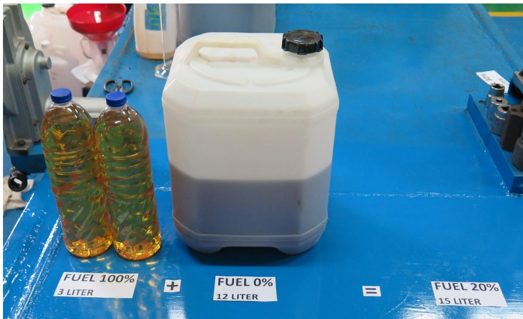
Gambar 3. 4 Pencampuran Biodiesel dengan Solar Murni
