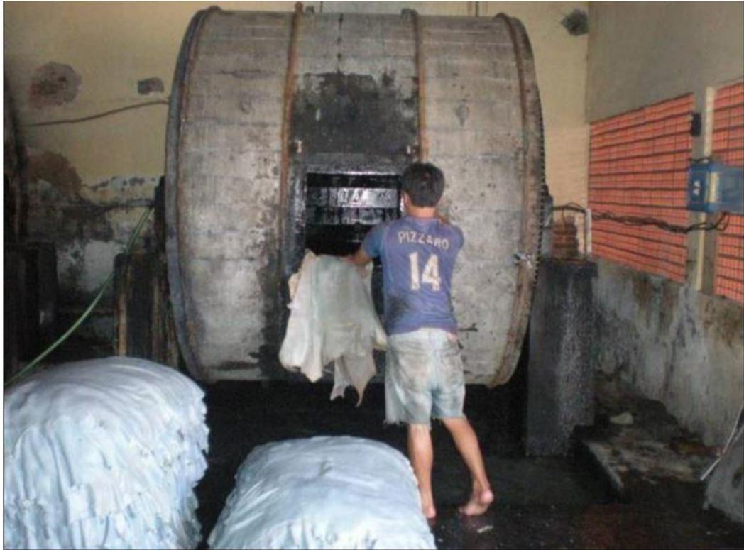
Gambar 2 1 Proses *Milling* di dalam drum
