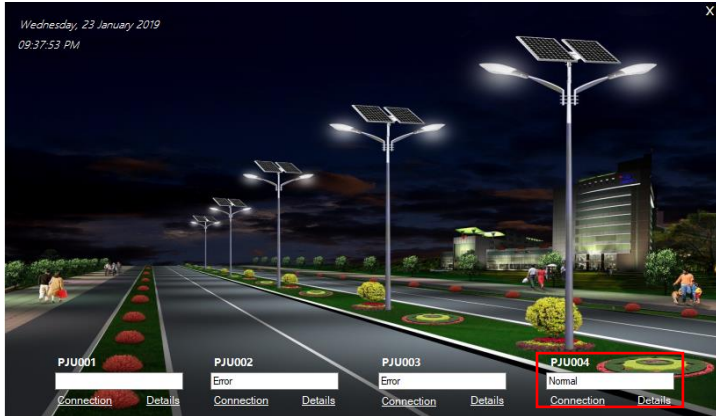
Gambar 4.38 Status Normal PJU004 pada Main Menu
