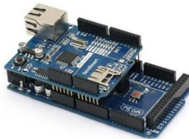
Gambar 3.6 Ethernet Shield dengan Arduino Mega 2560
