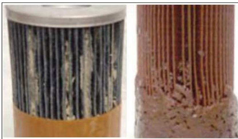
Gambar 3. 6 Penyumbatan pada filter bahan bakar
