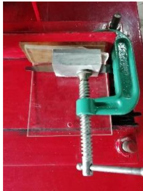
Gambar 3.14 Penggunaan feeler gauge untuk kedalaman potong
