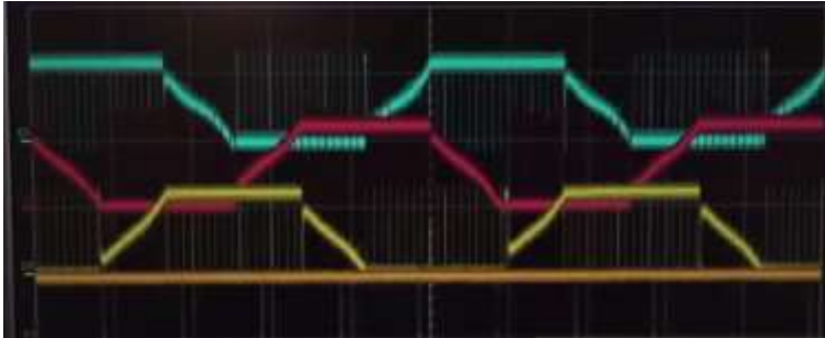
Gambar 2.6 Sinyal Output ESC Ketika Duty Cycle 99% [7]
