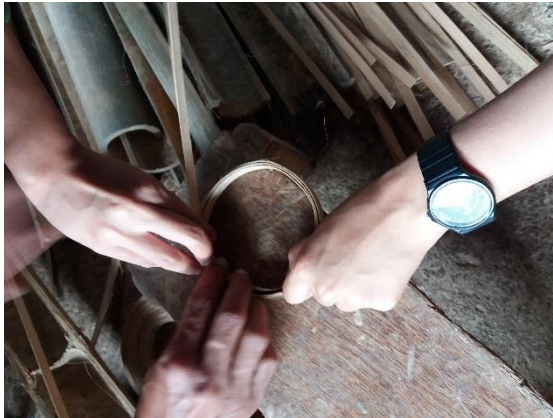
Gambar 7. Teknik Coiling Sumber : Penulis
