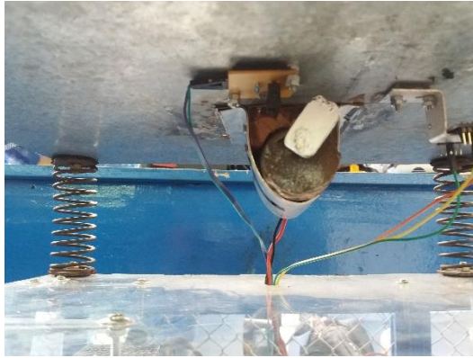
Gambar 4.4 Penempatan Sensor Optocoupler TCST1202
