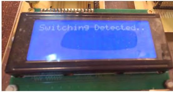
Gambar 4.20. Tampilan LCD Peralatan Pada Kondisi Switching 10 Lampu
