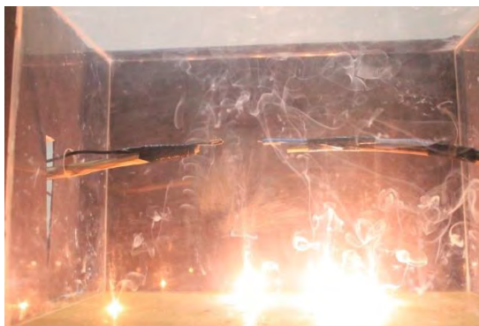
Gambar 3.11. Kondisi Fenomena Arcing
