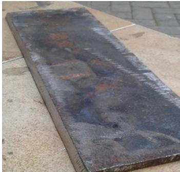
**Gambar 3.4** Material dengan sudut bevel 30<sup>0</sup>
