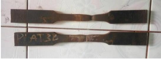
**Gambar 4.10** Patahan benda uji tarik pada kecepatan angin dalam ruang
