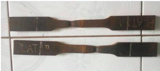
**Gambar 4.12** Patahan benda uji tarik pada kecepatan angin 1,70 m/s
