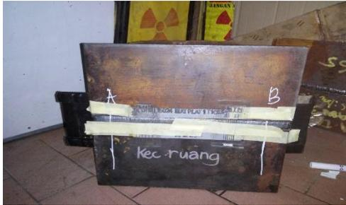
**Gambar 3.13** Spesimen Uji Radiografi
