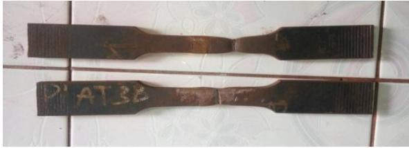
**Gambar 4.13** Patahan benda uji tarik pada kecepatan angin 2,1 m/s
