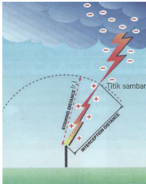
Gambar 2.3 Titik pertemuan kanal positif dan negatif dengan jarak sambar ( r_s ) ke struktur (R. Zoro, 2018)
