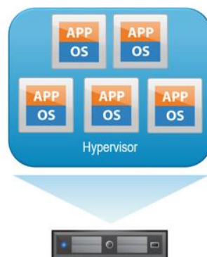
Gambar 2.4 Tipe 1 hypervisor atau di sebut “bare metal hypervisor” (Rockwell, 2015)
