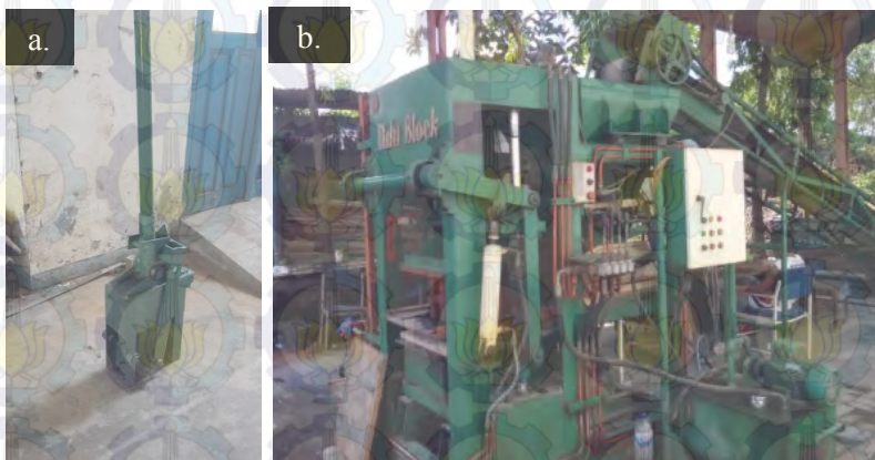
Gambar 4.35 (a) Alat cetak paving manual, (b) Mesin cetak paving otomatis
