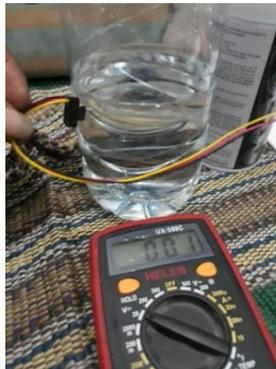
**Gambar 4.6** Validasi Sensor Level Pada Saat Terhalang Air
