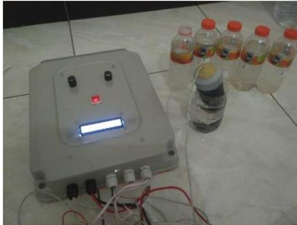
**Gambar 4.7** Proses validasi sensor kekeruhan
