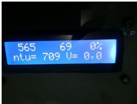
**Gambar 4.11** MOV Menutup 0 % Pada LCD
