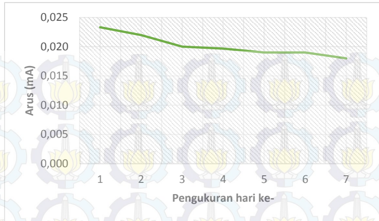
Gambar 31. Grafik Arus Proteksi pada Pipa dengan Luas Goresan Persegi Panjang 10 mm 2 dalam Media Tanah pH 11 selama 7 Hari
