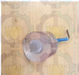
Gambar 3.6. Spesimen Uji Tafel Polarisasi
