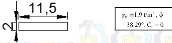
Gambar 4.10 potongan melintang timbunan tegak H = 2 \text{ m}
