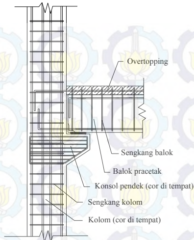
Gambar 2.7 Sambungan dengan cor setempat
