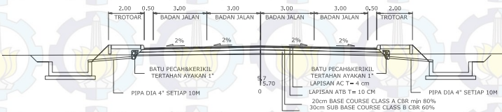
Gambar 1.5 Potongan melintang Sta 0+00 trase barat sisi utara
