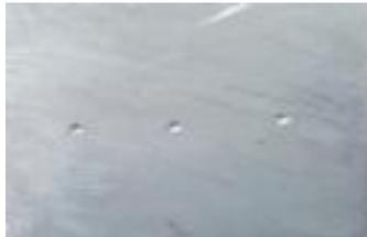
Gambar 4.1 Hasil Penetrasi dari Indentor Mesin *Vickers*
