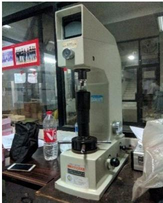
Gambar 3.4 Mesin Pengujian Vickers
