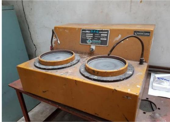
Gambar 3.8 Mesin *Grinding* dan *Polishing*
