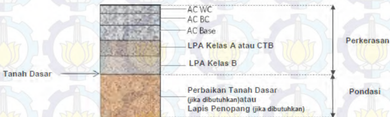
Gambar 2.1 Struktur Perkerasan Lentur (Lalu Lintas Berat) pada Permukaan Tanah Asli ( At Grade )
