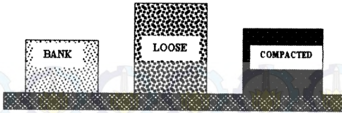
Gambar 2.1. Keadaan Material Dalam Earth Moving
