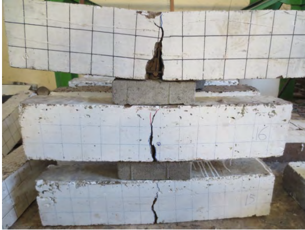
Gambar 4. 7 Pola retak yang terjadi pada benda uji dengan kombinasi perawatan tanpa oven – laut (TO-L)
