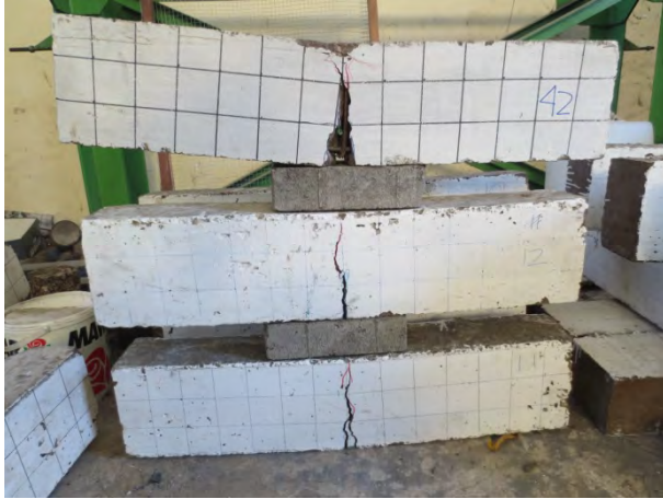
Gambar 4. 5 Pola retak yang terjadi pada benda uji dengan kombinasi perawatan oven-laut (O-L)
