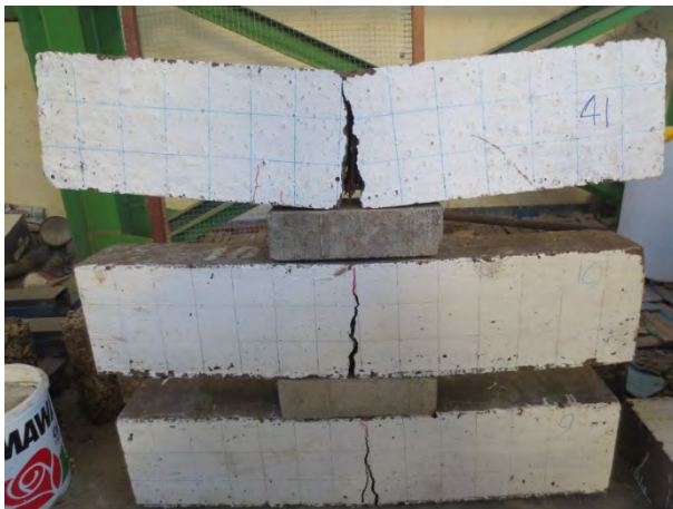
Gambar 4. 4 Pola retak yang terjadi pada benda uji dengan kombinasi perawatan oven-ruang (O-R)
