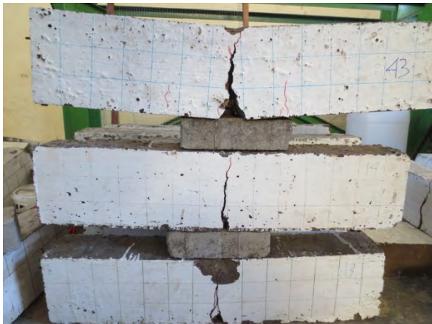
Gambar 4. 6 Pola retak yang terjadi pada benda uji dengan kombinasi perawatan tanpa oven – ruang (TO-R)
