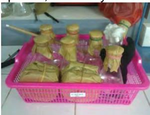
6. Dimasukkan ke dalam autoclave 121°C selama 1 jam
