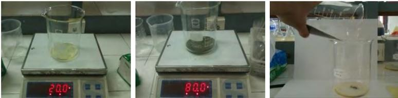
**Gambar 3. 4 Proses Penimbangan dan Pencampuran Tanah dengan Minyak**
