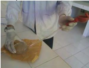
11. Tambahkan media NA steril yang telah didinginkan setelah dipanaskan (suhu sekitar  $47-50^{\circ}\text{C}$ ) ke dalam masing masing cawan petri kemudian digoyang-goyangkan supaya media menyebar dan merata. Penambahan media NA juga dilakukan secara aseptik.
