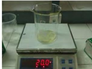
2. Untuk membuat larutan surfaktan konsentrasi 0,02, ambil 20ml Surfaktan Tween-80 dengan pipet ukur kemudian letakkan di *beaker glass* ukuran 1000 ml. Untuk membuat larutan surfaktan konsentrasi 0,04 ambil surfaktan sebanyak 40ml.
