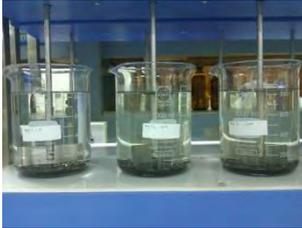
6. Jartest dinyalakan dan disetting dengan kecepatan 300rpm selama 1 jam.
