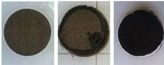
**Gambar 3. 5 Perubahan Warna Tanah Sebelum dan Sesudah Dicampur dengan Minyak**
