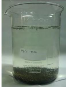
5. Letakkan sampel tanah yang telah diisi dengan larutan surfaktan ke dalam *paddle* pada alat jartest.
