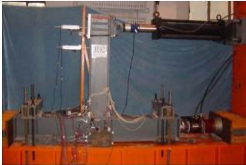
Gambar 2.13 Test set-up yang dilakukan Sumber : Gang Shi et al., 2006
