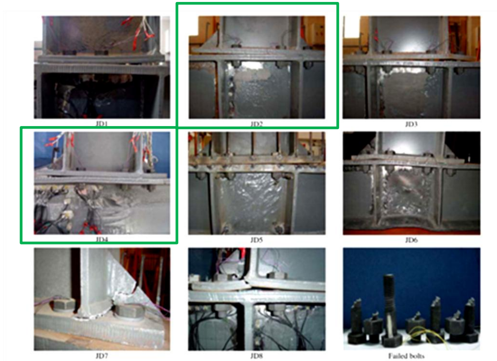
Gambar 2.14 Mode kegagalan dari spesimen Sumber : Gang Shi et al., 2006
