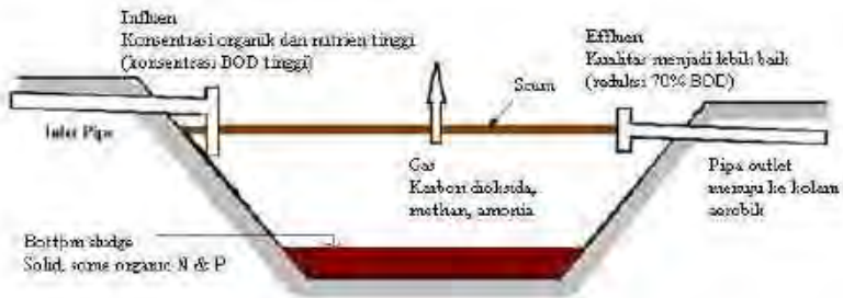
Gambar 2.5 Potongan Kolam Anaerobik
